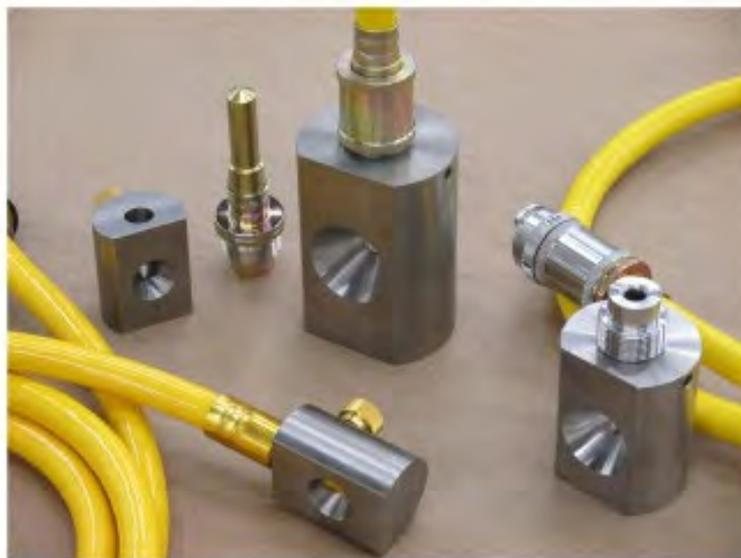
Questi sistemi di collimazione contengono e dirigono il fascio di radiazioni durante l'esposizione. Questo si traduce in una migliore qualità radiografia e condizioni operative sicure. Essi sono costituiti da un corpo in acciaio inox contenente due inserti di tungsteno. I collimatori direzionali in tungsteno dirigono il fascio di radiazioni con un angolo di apertura di 60°. Possono essere collegati direttamente ad un tubo SENTINEL per gammagrafia.
